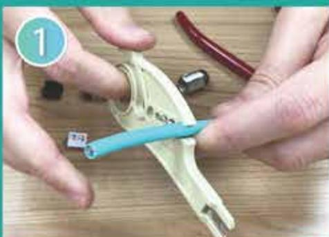
1 用開皮刀把 3M Cat.6A U/FTP 網絡線約20mm-30mm長的外皮剝掉。
