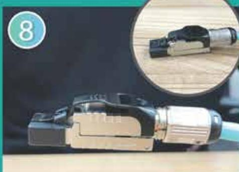
8 再把 EXW Cat.6A FTP 免工具插頭合好，並鎖上護套(步驟2提及的)後便完成接駁。
