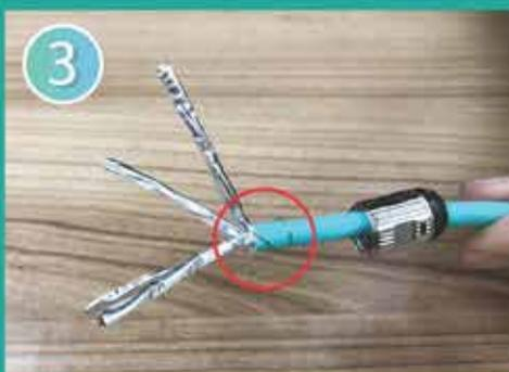
3 把4對雙絞線分開後，將中間的 drain wire (排擾線)繞於網絡線的外層。
