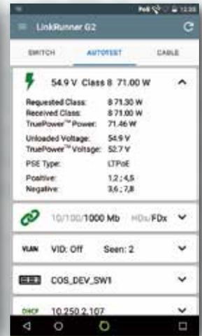
TruePower™ PoE Loading Test (IEEE 802.3bt, 71W)
