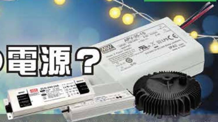
LED電源(LED Driver) 是一種電壓轉換器，為LED燈專用之驅動裝置，可以提供恆定電流、恆定電壓或由調光器控制的可變電流。不適當的LED電源對LED性能有非常大的負面影響，因此選用正確及高穩定性的LED電源是十分重要。一般應用在白光LED的順向電壓為3.0-3.6V左右；典型電壓為3.3V；電流為20mA，若LED兩端的電壓數值相加後超過3.6V後，經LED的電流會隨順向電壓增加而急速上升，導致LED溫度快速升高，從而加快LED的光衰減，引致LED壽命縮短，甚至燒壞。恆定電流(Constant Current)驅動則能解決以上問題。
