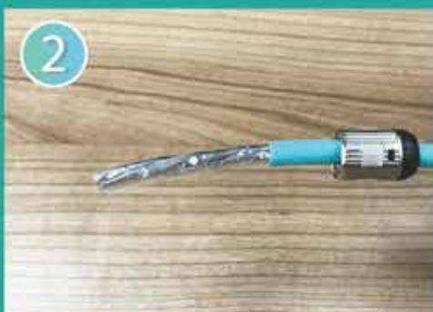
2 先將護套套入網絡線中，再把已開皮位置的屏蔽層除去(如有)。
