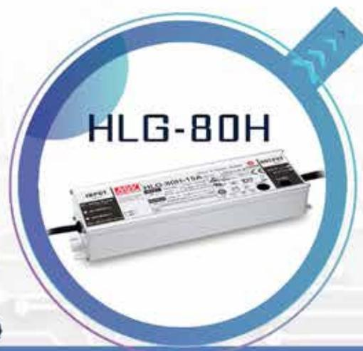
MEAN WELL HLG-80H 系列為交流變直流的電源供應器，以恆流輸出和恆壓輸出設計為主要特色。此系列機型可在輸入電壓90-305VAC工作，並提供輸出額定電壓介於12V-54V間的多種機型。因HLG-80H具有最高可達91%之高轉換率，內建主動式功率因數矯正功能(Active PFC)，可於自然風冷散熱下，操作於-40°C~+80°C溫度範圍之間。HLG-80H備有短路、過電流、過電壓和過溫度等保護，並擁金屬外殼及IP67 / IP65高防護等級設計，使其均適用於戶內或戶外應用。同時HLG-80H搭配了多種功能選項(如數種調光方式)，為燈具系統提供最佳的設計彈性。此系列具備7年保養，絕對具信心保證。
