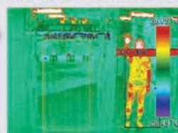
透過ROI技術，可避免無需檢測的目標，確保沒有漏檢。 設置顏色警報，清晰地捕捉發熱區域。
