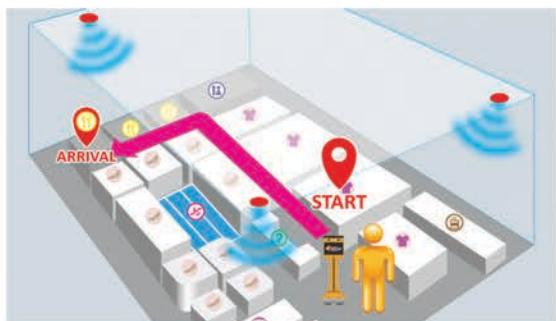
■ 機械人能根據beacon發出的訊號自動行走，準確將客戶帶到所需位置
