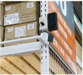
XYZ服務機械人利用beacon進行定位及路線計算，準確度及訊號也較穩定。
