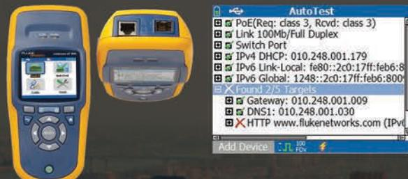
LinkRunner AT 2000 一鍵式自動測試可數秒內完成所需測試
