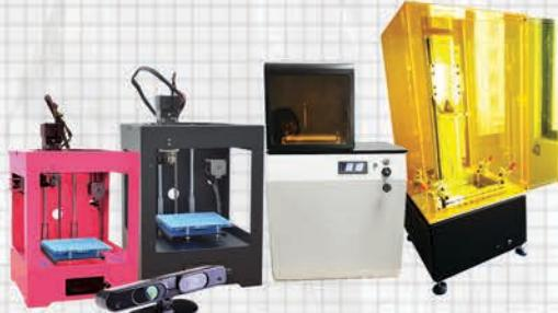
• 不同種類的 3D 打印機，包括 FDM、DLP、LCD 及 3D 掃瞄器
